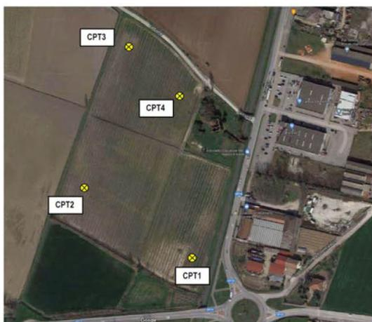
Ubicazione prove penetrometriche statiche CPT utilizzate per gli approfondimenti geolitologici
